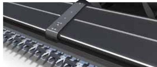
Le lamier est à une distance impressionnante de 1,14 m de la vis d'alimentation, pour une vision et des performances optimales. Les tapis de convoyage PowerFlow robustes éloignent la récolte du lamier vers le convoyeur à une vitesse régulière. Les tapis dévient aussi les pierres plutôt que de les conduire dans la machine où elles pourraient causer des dommages.
