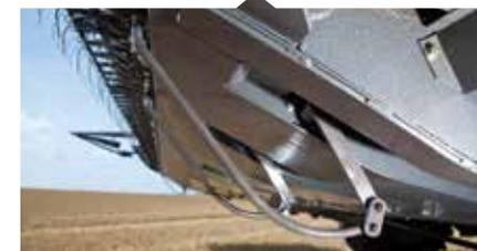
La commande de table AutoDevers est disponible en option en association avec la commande automatique de hauteur de coupe. La transition sans heurt d'un côté à l'autre permet d'assurer une hauteur de coupe constante avec une grande sensibilité, résultat de la collaboration idéale de composants électroniques et hydrauliques de qualité.
