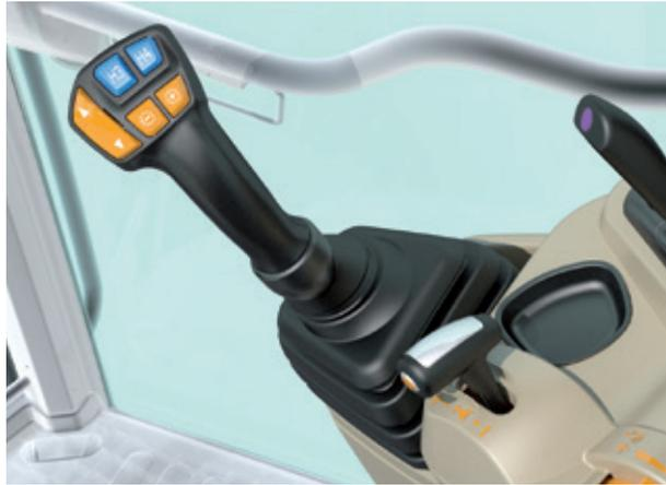
Version de cabine Essentiel du MF 5700 S avec joystick multifonction à commande électrique
