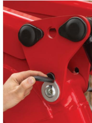
**Facilité d'entretien** – les points de graissage tournés vers l'extérieur sont facilement accessibles et bien protégés
