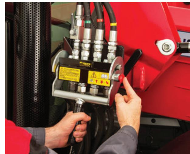
Déconnecter les raccords hydrauliques et électriques
