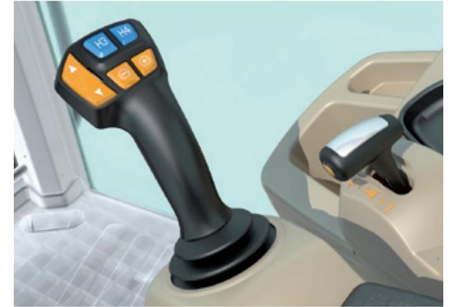
Version de cabine Efficient avec joystick multifonction à commande électrique et accoudeur
