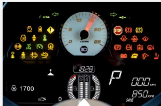
Le **tableau de bord intelligent** sur les MF 5700 Dyna-4 affiche les régimes du moteur et de la prise de force, les intervalles d'entretien, la consommation de carburant, la distance parcourue, la surface travaillée, la température de l'huile, les heures de fonctionnement du tracteur, le régime moteur programmé et des informations relatives à l'entretien.
