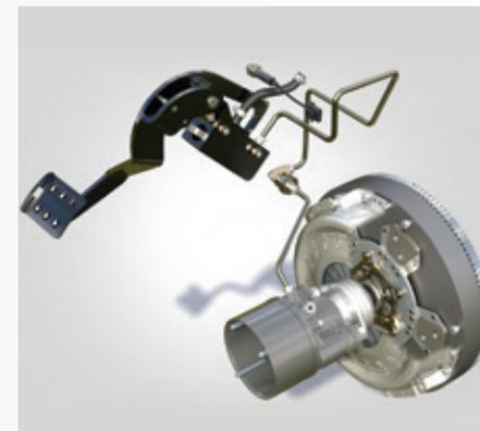
La transmission étant entièrement nouvelle, les ingénieurs Massey Ferguson ont conçu la pédale d'embrayage en mettant la priorité sur le confort d'utilisation. Cette nouvelle conception permet de réduire l'effort et de rendre le passage de vitesses aussi doux que dans une voiture moderne.
