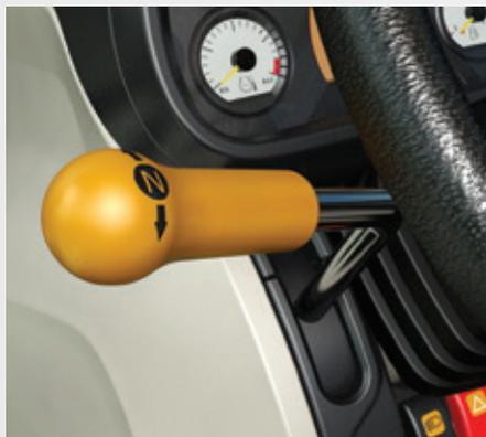
Le levier d'inverseur mécanique synchronisé situé sur le tableau de bord facilite le changement du sens d'avancement pour les manœuvres en fourrière et la manutention, ainsi que pour l'attelage d'outils (en standard sur les MF 4700 en version arceau).
