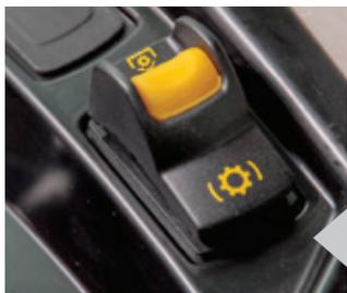
L'engagement de la prise de force reste électro-hydraulique avec le même contacteur de sécurité à 3 positions (Marche, Arrêt et Blocage/frein).
