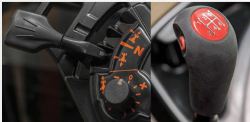
En option sur les MF 4700 et en standard sur tous les MF 5700 et MF 6700, le levier Power Control à main gauche garantit une utilisation trois-en-un et en toute simplicité de la transmission. L'opérateur peut inverser le sens d'avancement et sélectionner la position neutre. Pour davantage de précision, la réactivité de l'inverseur peut être réglée au moyen de la molette Comfort Control, la combinaison ultime pour travailler avec un chargeur frontal.
