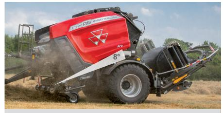
L'angle du flux du fourrage du nouveau combiné Protec est réduit, ce qui permet de limiter la hauteur hors tout de la presse et ainsi d'améliorer la stabilité, pour des opérations en pente plus sûres et plus rapides. Cela permet aussi d'améliorer l'alimentation et ainsi d'optimiser le débit de récolte et de minimiser le risque de bourrage.
