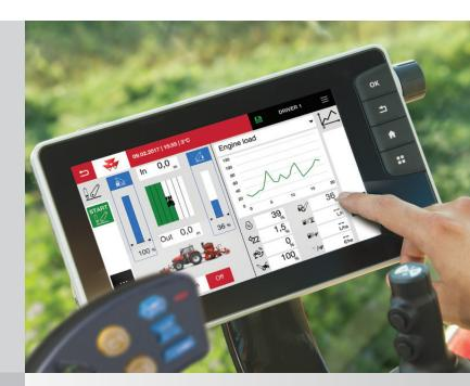
La presse à balles MF 4160V Protec peut intégrer une connexion ISOBUS pour utiliser les terminaux du tracteur.
