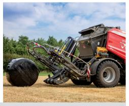
Afin d'assurer un déchargement fluide des balles, la table d'enrubannage est rabaissée près du sol, ce qui minimise la vitesse de dépose de la balle, prévient l'endommagement du film et maintient la forme idéale de la balle. Un retourneur de balles en option empêche les balles de rouler et facilite le chargement sur la remorque. L'opérateur peut aussi choisir entre les modes de déchargement automatique et manuel.
