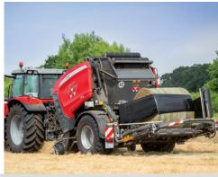
Une fois la balle transférée au centre de la table d'enrubannage, un carrousel entraîné hydrauliquement commence à tourner avant même que la porte soit complètement fermée, ce qui permet de terminer le cycle bien avant que la balle suivante soit prête pour l'enrubannage. Conçu pour supporter les charges de balles les plus lourdes, le châssis robuste avec son carrousel silencieux opèrent en douceur et sans effort pour enrubanner balle après balle.
