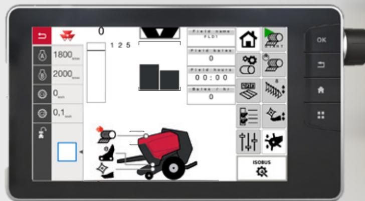
Si le tracteur attelé est doté de la commande ISOBUS, il est également possible d'utiliser l'écran du tracteur pour afficher les informations principales du tracteur et de la presse en un endroit unique.
