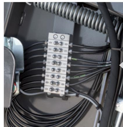
Une lubrification suffisante et régulière des roulements à rouleaux est très importante, notamment dans des conditions difficiles comme le pressage d'ensilage. Les banques de graisseurs centralisés destinées au graissage des roulements à rouleaux sont stratégiquement situées, pour un accès facilité et un temps d'entretien réduit.
