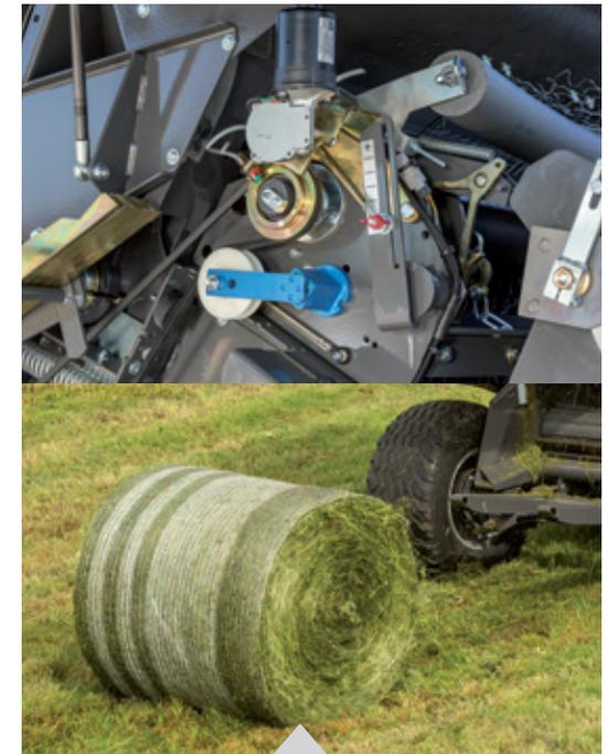
En option, le système Variotwin offre un liage de balle simple et économique. Le contrôle de vitesse variable exclusif permet des tours de ficelle supplémentaires sur les bords de la balle afin d'en sécuriser les extrémités et d'augmenter la vitesse de liage générale, un avantage considérable lors du pressage de récoltes légères.
