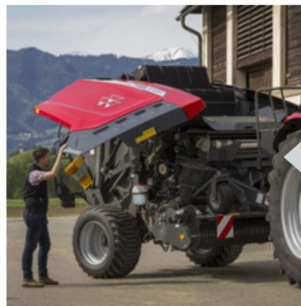
Les grands capots latéraux pleine largeur facilitent l'accès pour l'entretien. La conception avec une surface lisse évite l'accumulation de résidus sous les panneaux tandis que le verrouillage de sécurité évite les ouvertures accidentelles et les éventuels dommages.
