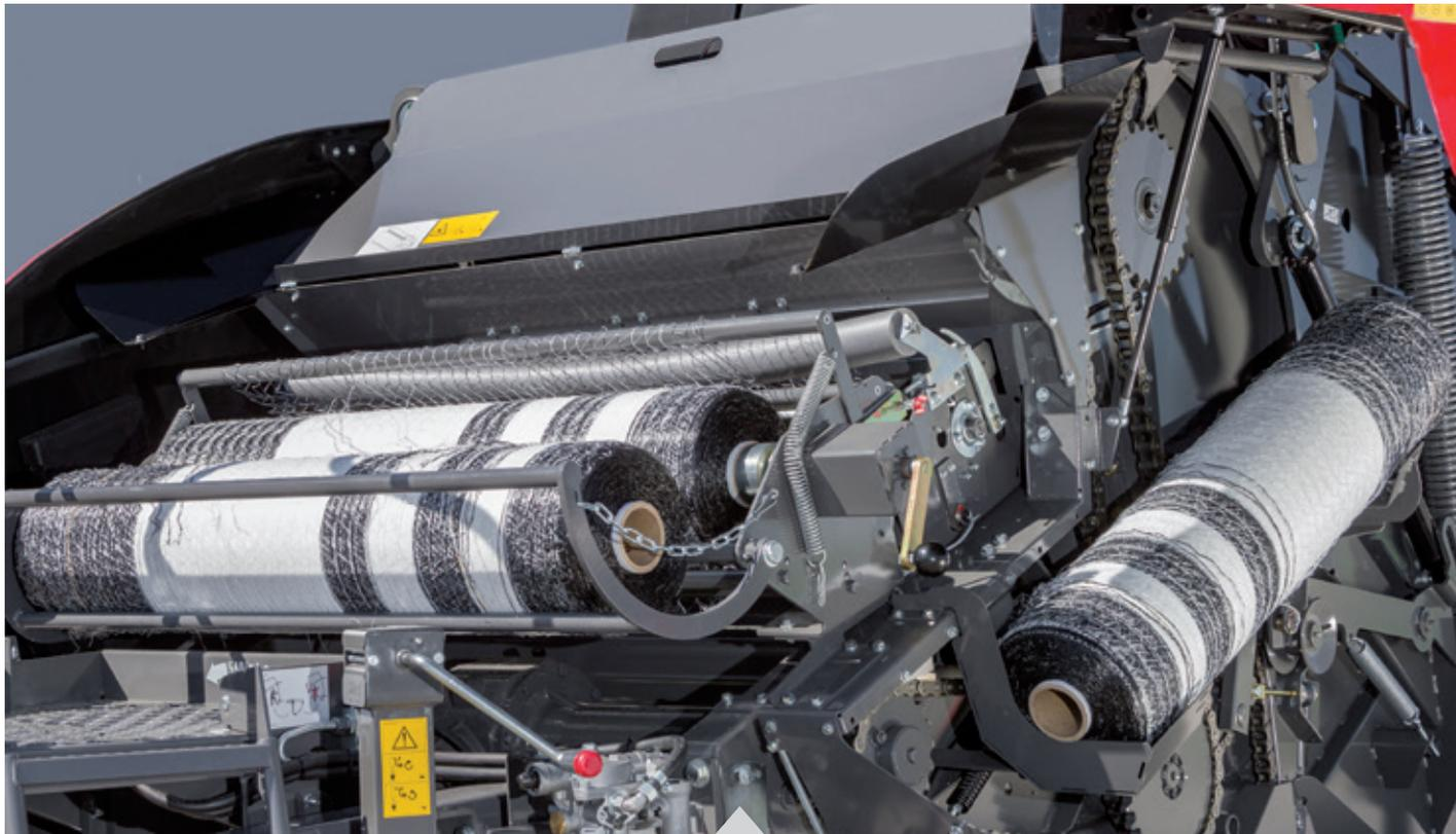
Le **système Easy Loading System (ELS)** permet d'emporter un rouleau de rechange sur la presse pour ainsi pouvoir remplacer le rouleau terminé en quelques minutes. Outre l'ELS, la plupart des modèles intègrent un rangement pour un rouleau de filet supplémentaire sur le côté gauche de la presse à balles afin d'optimiser le temps de travail au champ.
