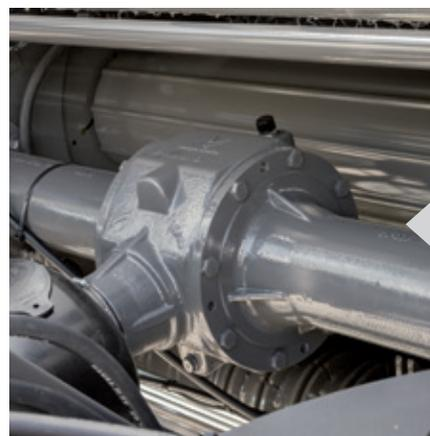
Le boîtier Powersplit divise et transfère la puissance de façon égale pour entraîner le système d'alimentation d'un côté et la chambre de pressage de l'autre, réduisant ainsi le besoin total de puissance en simplifiant les transmissions. La presse est ainsi plus efficace, consomme moins de puissance, et par conséquent moins de carburant.
