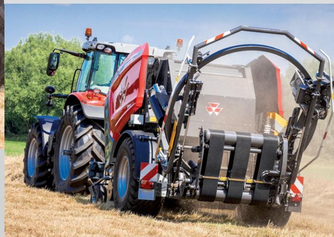
En mode transport, le carrousel d'enrubannage est relevé vers l'avant afin de réduire la longueur hors tout de la machine à seulement 5,9 m pour un transport plus sûr et une maniabilité accrue.
