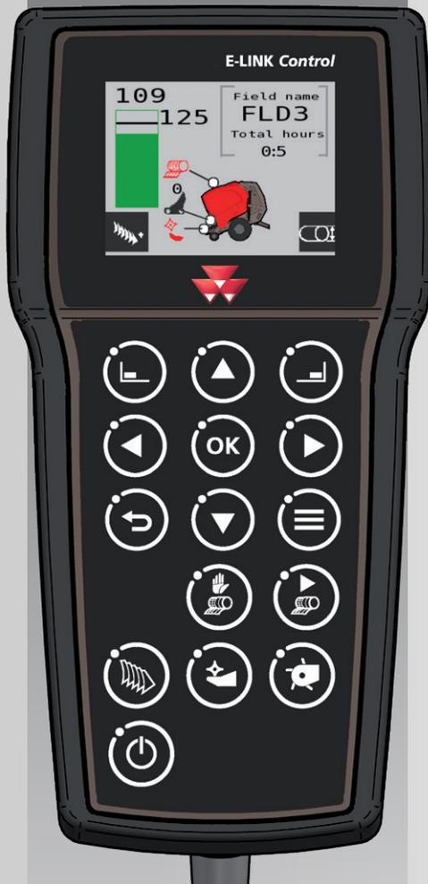
Le terminal E-Link Control de série sur le Massey Ferguson RB 3130F permet à l'utilisateur d'avoir un bon aperçu des principales fonctions de la presse, tous les réglages pouvant être effectués sur le moniteur. Son écran haute définition affiche des images claires.
