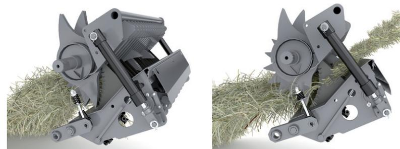
Le système de protection breveté évite que les pointes de charge provoquent des bourrages en descendant délicatement l'avant du fond d'ameneur grâce à des blocs en caoutchouc ou des ressorts en acier, selon le modèle.
