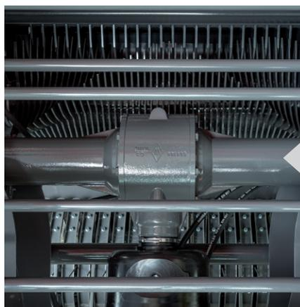
Le boîtier Powersplit répartit la puissance pour entraîner le rotor d'un côté et la chambre de pressage de l'autre, ce qui réduit la demande de puissance générale en simplifiant la transmission, pour une presse à balles rondes beaucoup plus efficace et qui consomme moins de carburant.
