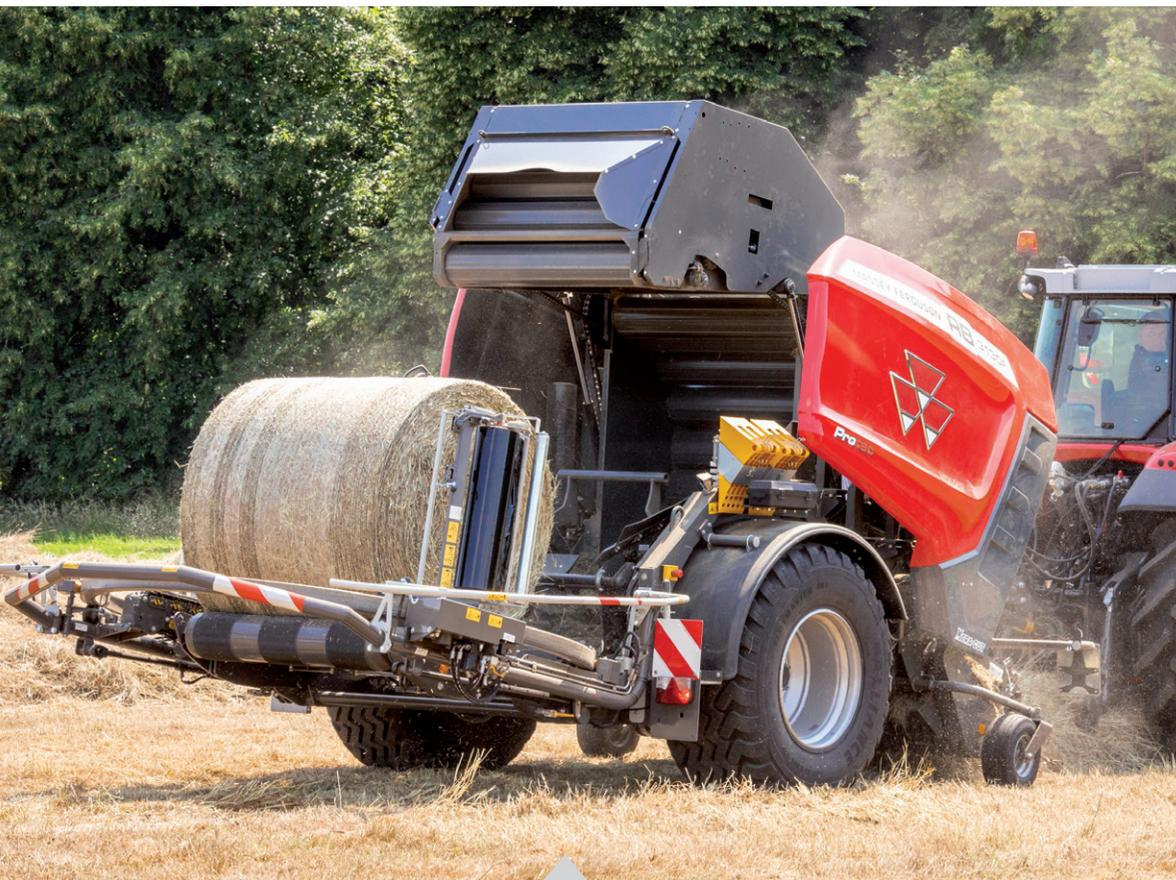
L'angle du flux du fourrage du nouveau combiné est réduit, ce qui permet de limiter la hauteur hors tout de la presse et ainsi d'améliorer la stabilité, pour des opérations en pente plus sûres et plus rapides. Cela permet aussi d'améliorer l'alimentation et ainsi d'optimiser le débit de récolte et de minimiser le risque de bourrage.
