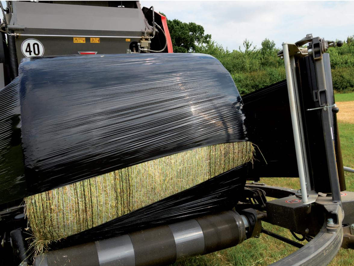
La table d'enrubannage entraînée hydrauliquement se compose de deux rouleaux et de trois courroies sans fin installés sur un châssis soudé pour plus de durabilité. Un capteur situé sous la courroie centrale permet de commencer l'enrubannage uniquement lorsque la balle est complètement positionnée sur la table, tandis que quatre grands rouleaux de support latéraux maintiennent la balle centrée pendant l'enrubannage.
