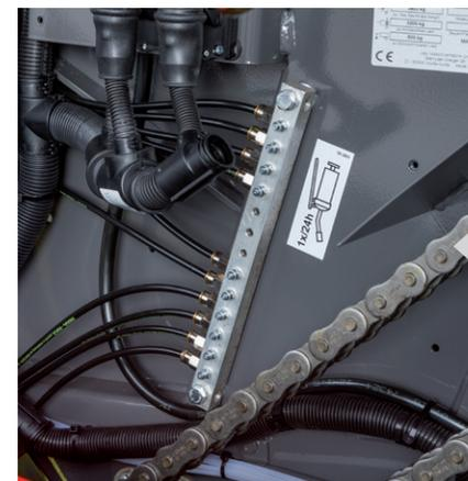
Une lubrification suffisante et régulière des roulements à rouleaux est très importante, notamment dans des conditions difficiles comme le pressage d'ensilage. Les banques de graisseurs centralisés pour la lubrification des roulements à rouleaux sont stratégiquement situées pour en faciliter l'accès et réduire le temps d'entretien.
