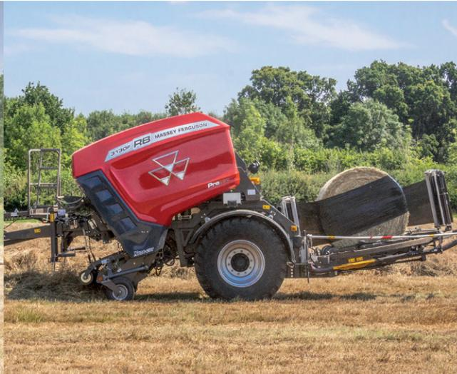
Afin d'assurer un déchargement fluide des balles, la table d'enrubannage est abaissée, ce qui minimise la vitesse de roulement de la balle, prévient l'endommagement du film et maintient la forme idéale de la balle. Un retourneur de balles en option place les balles sur leurs flancs, ce qui les empêche de rouler et facilite le chargement sur la remorque. L'opérateur peut aussi choisir entre les modes de déchargement automatique et manuel.
