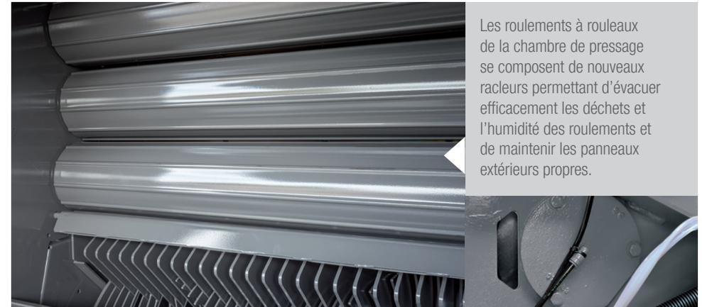
Les roulements à rouleaux de la chambre de pressage se composent de nouveaux racleurs permettant d'évacuer efficacement les déchets et l'humidité des roulements et de maintenir les panneaux extérieurs propres.
