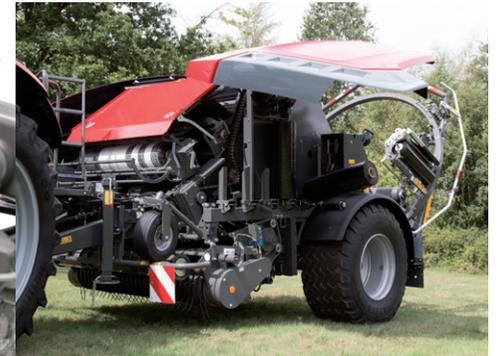
Douze supports de rouleaux de film sont idéalement situés à une hauteur confortable de chaque côté de la presse à balles ainsi que deux rouleaux supplémentaires sur l'enrubanneuse, pour une productivité accrue.
