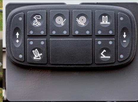
Un panneau de contrôle externe situé à l'arrière de la presse permet de contrôler la porte, le carrousel et la table d'enrubannage ainsi que les pinces film, ce qui facilite les changements de rouleaux, la maintenance et le nettoyage.
